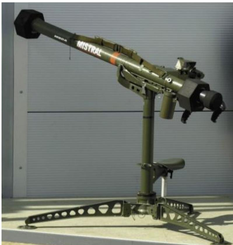
**Origine :** CMatérielle monté sur tripode, il est développé en 1979 sous le nom de "Mistral" ; les premiers essais de tir ont lieu de 1983 à mars 1988. La mise en service opérationnelle est prononcée en janvier 1990, il est utilisé en 1991 durant la guerre du Golfe, mais c'est en 1996 qu'arrive la première commande à l'export.
